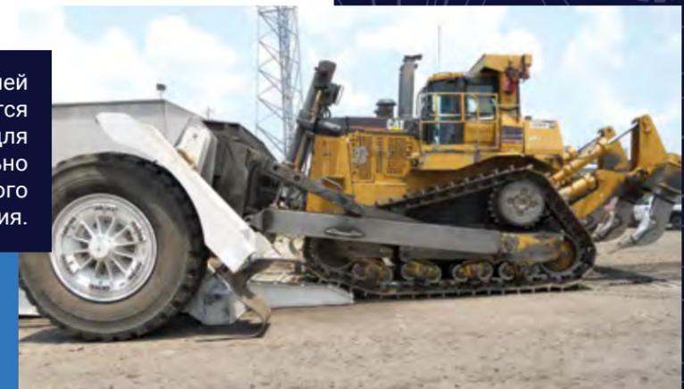
Низкорамный трал с задней загрузкой TowHaul является идеальным выбором для транспортировки осительно малогабаритного оборудования.
